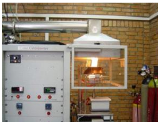
Figura 2.10 Eliberarea căldurii în calorimetrul cu con, RHR, ISO 5660-1
